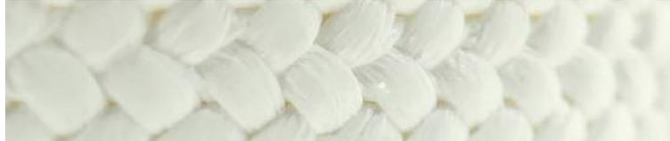
Fabricada de fibra de Ramie de alta resistencia impregnada con PTFE o grafito.
